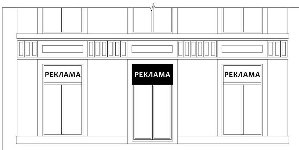
Спеціальна конструкція розміщена у прорізі не виходячи за його межі
